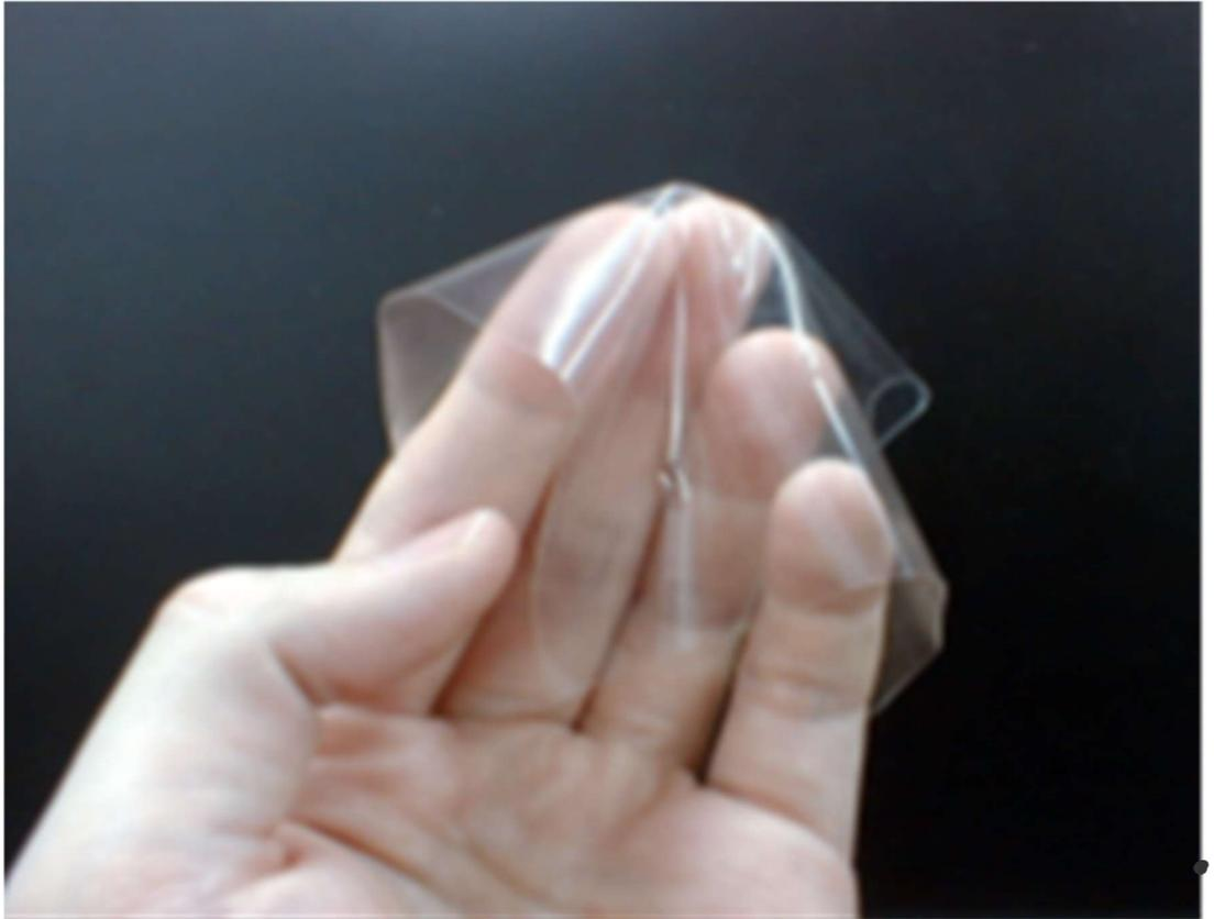
ポリジメチルシロキサン（PDMS）系有機・無機ハイブリッド材料透明シートの例：100 $\mu$ m厚で5 kVの電圧を印加しても絶縁を保つことができます。
