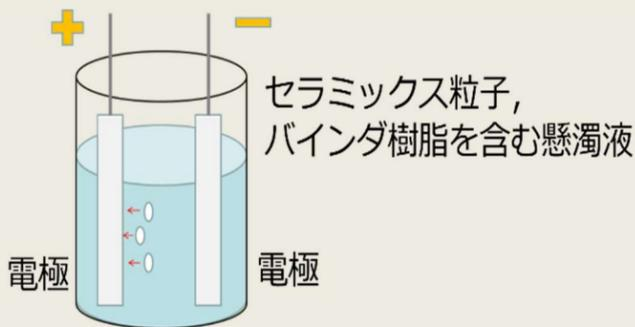
電気泳動堆積法：懸濁液の中の帯電した粒子や樹脂材料は、電界の効果により移動し、電極上へと堆積します。
